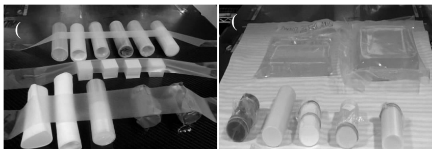
Figura 1. (a)- primeiro teste e (b)- segundo teste, realizados com materiais tecido equivalentes submetidos à CT para verificação da homogeneidade e número Hounsfield (HU) de cada composto testado.
